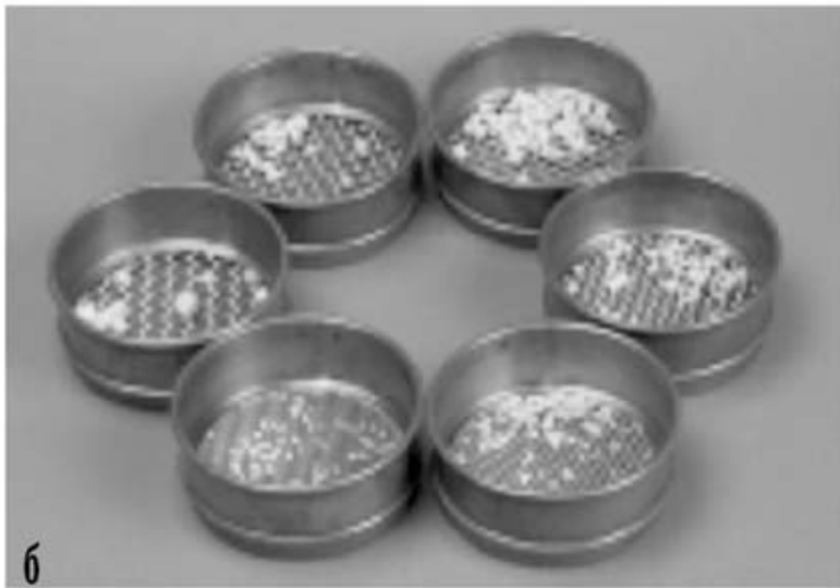
Рис. 4. Проба, проводимая путем просеивания тестового материала через сито: а – метод одного сита, б – метод нескольких сит
