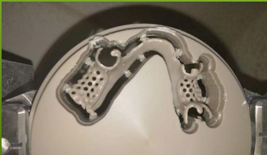
Приклад фрезерування каркасу бюгельного протеза зі стандартного акрикетонного полімерного (АКР) блоку
